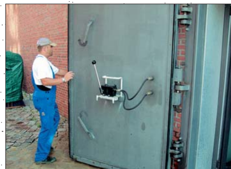
Mobile hydraulische Handpumpe zum Heben/Senken des Türblattes in den Türangeln.
