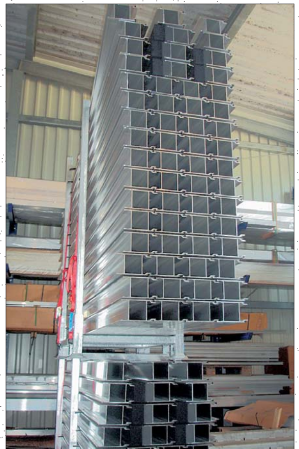
Dammbalkenrungenpalette verzurrt und übereinander gestapelt
