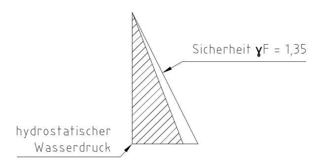
Der hydrostatische Wasserdruck wird mit einer Wichte von 10 kN/m³ berechnet.
